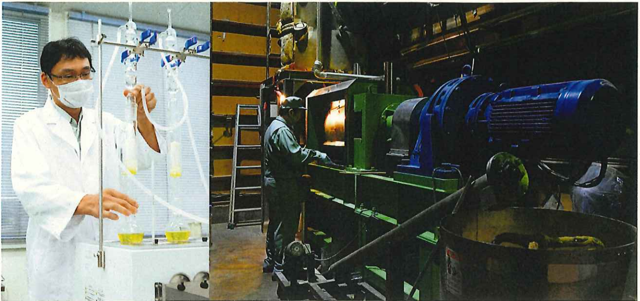
左/2020年9月に竣工した「R&Dセンター」での研究風景。同社の栄養補助食品「ハイブレフ」に含まれる油分の比率を測定するため、有機溶剤で油を分離する。こののち測定器で計測する。右/ハイブレフのもととなる米ぬかを絞る圧搾機。
